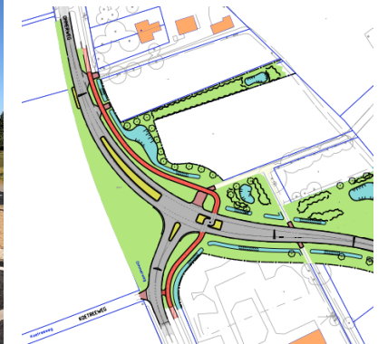
Aansluiting Ommerweg: een royale aansluiting, met brede middengeleiders. Fietzers kunnen in twee etappes oversteken, maar de snelheid van het verkeer op de noordzuidverbinding wordt niet getemperd.
