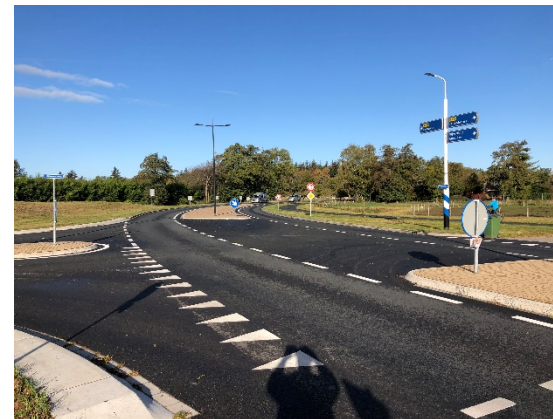
Aansluiting Ommerweg: een royale aansluiting, met brede middengeleiders. Fietzers kunnen in twee etappes oversteken, maar de snelheid van het verkeer op de noordzuidverbinding wordt niet getemperd.
